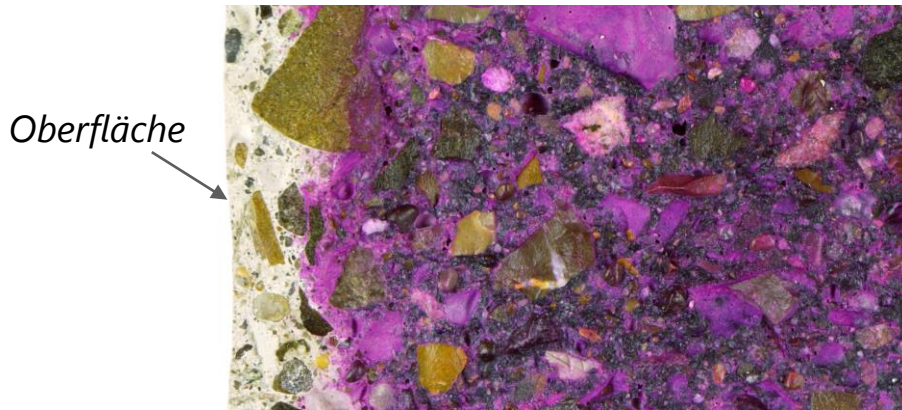
carbonatisiert nicht carbonatisiert (eingefärbt)
