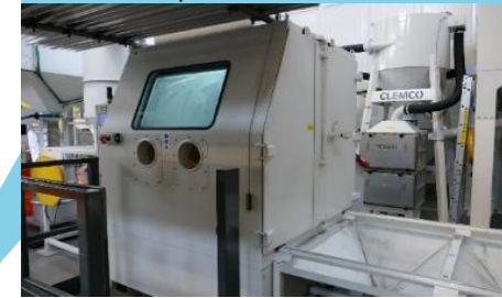
Grenailage (Boite à gants): en exploitation depuis septembre 2021
