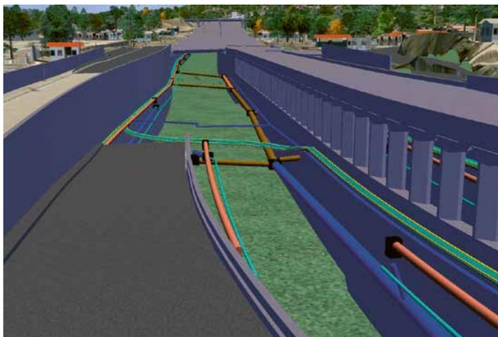
Figure 4 : Représentation des réseaux d'assainissement (plans 2D «remontés» en 3D)
